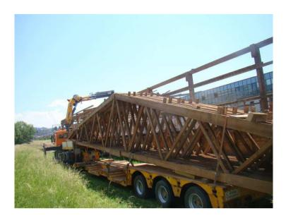
3-Achs Sattelschlepper mit Ladekran in Kombination mit Auflieger/Tiefladeauflieger. Ideal für den Transport von sperrigen Gütern, die mit dem Kran auf- oder abgeladen werden müssen. Oder als Kranfahrzeug solo mit einer kleinen Brücke können auch enge Baustellen befahren werden. Kleine Aufricht- und Montagearbeiten sind mit der grossen Reichweite von 25m kein Problem.
