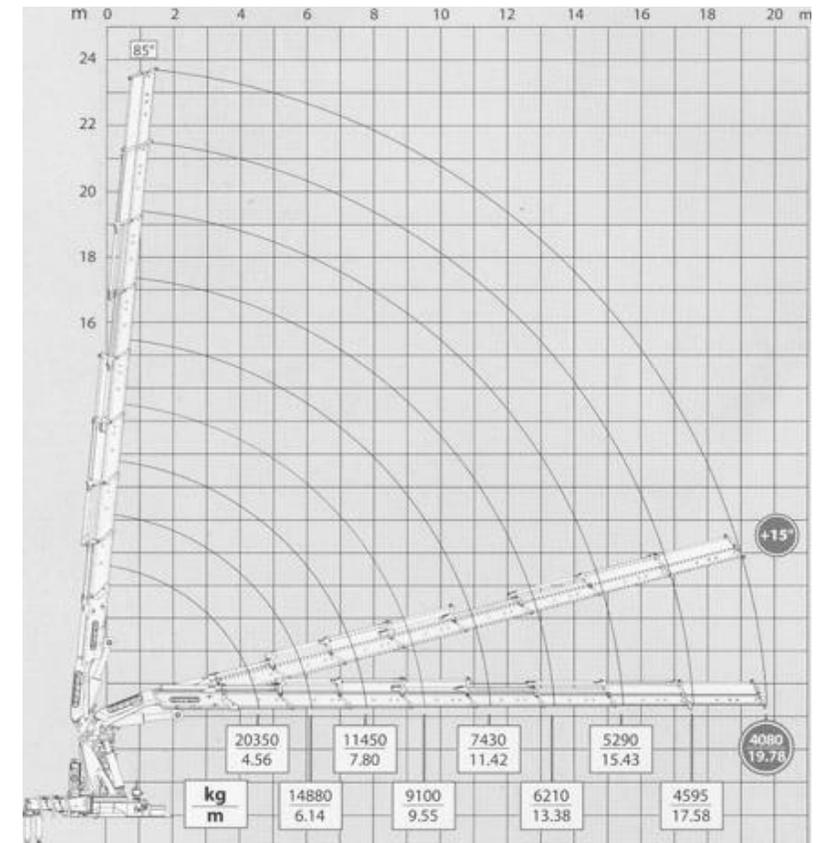
Es ist möglich mit dem Grundkran sehr grosse Lasten zu heben. Durch seine spezielle X-Cross Abstützung kann der Kran auf 360° mit 100% Ausladung arbeiten. Der Kran ist auch ideal für Greiferarbeiten auf grosse Distanz.
