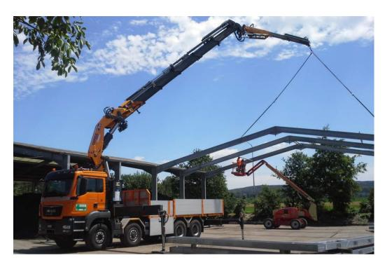
4-Achser Lastwagen mit Ladekran und fester Ladebrücke. Geeignet für den Transport von Container eventuell in Kombination mit Anhänger. Mit seiner grossen Reichweite ideal zum Aufrichten von Holz-, Metallkonstruktionen oder zum Montieren von Glasscheiben.
